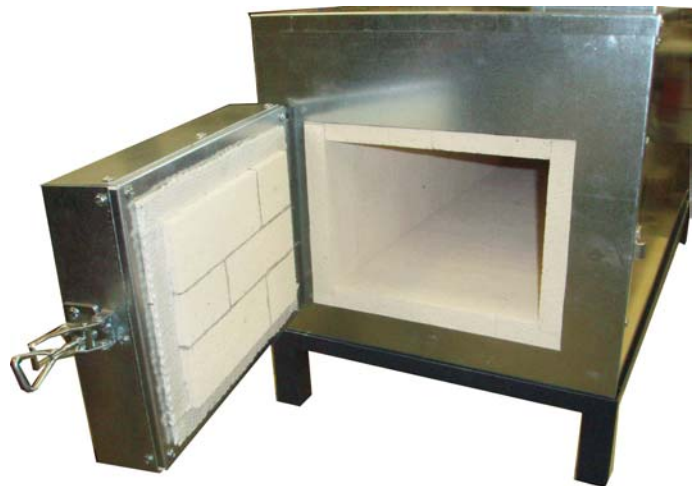
Ugn för härdning av smidda knivstål. Max temp 1250 grader
